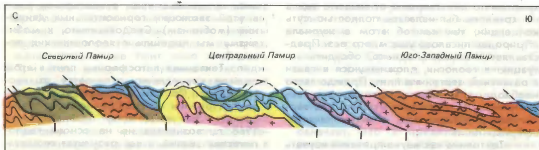
Тектонические покровы на Памире (по С. В. Руженцеву), иллюстрирующие тектоническую расчлененность земной коры и сжатие масс.
